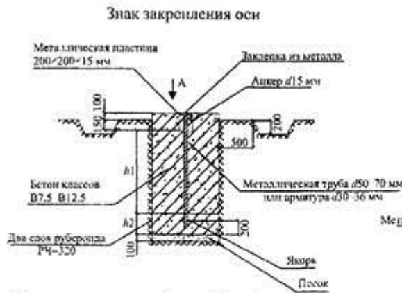
Знак закрепления временных осей и точек внутренней разбивочной основы
